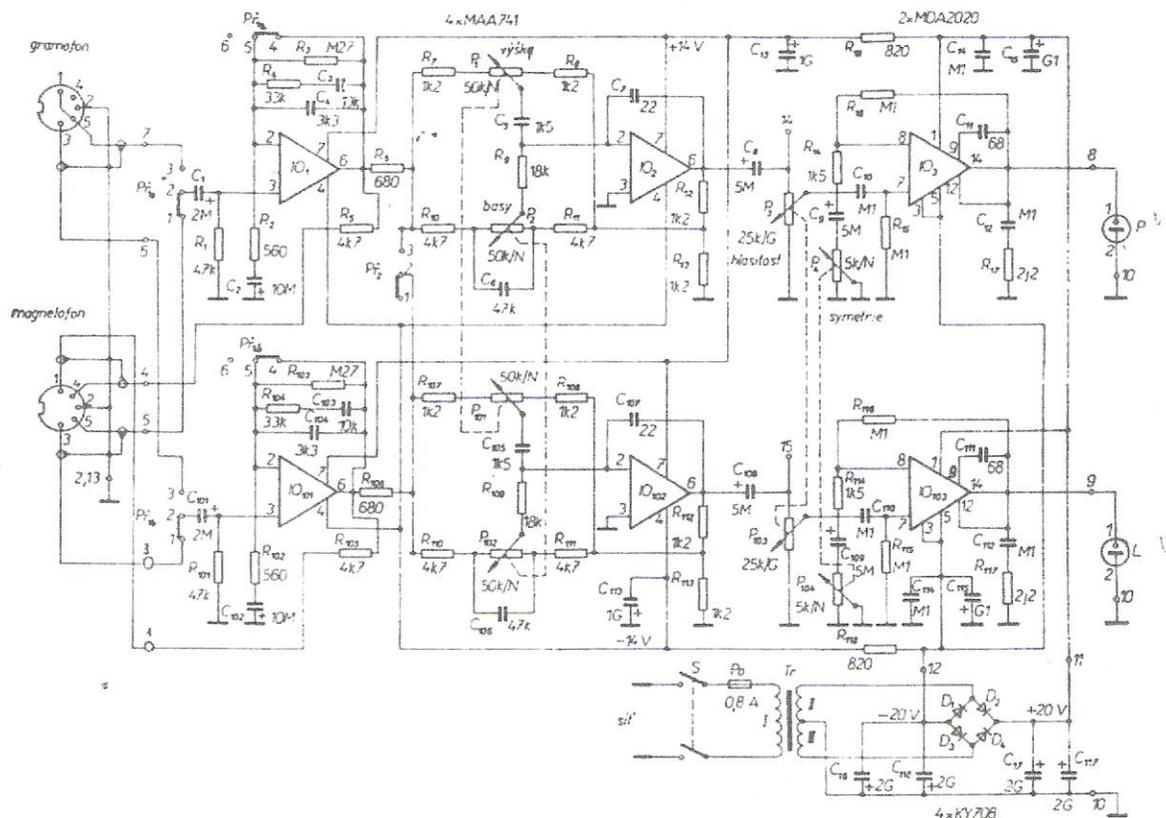
Uvedené zapojenie vychádza z požiadavku počtu aktívnych i pasívnych prvkov, pričom parametre odpovedajú triede HIFI. V zosilňovači sú použité operačné zosilňovače typu MAA 741 a výkonové integrované obvody MDA 2020. Prvý stupeň pracuje jednak ako korekčný zosilňovač, ďalej ako napäťový sledovač signálu zo vstupu pre magnetofón. Na vstupe druhého zosilňovacieho stupňa sú zapojené regulátory hĺbok a výšok. Zosilňovač je napájaný zo zdroja symetrického ss napätia.
